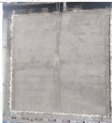
شکل ۳: سطح غیر معرض با پوشش ۲/۵ سانتی‌متر ملات ماسه و سیمان (قبل از آزمون)
