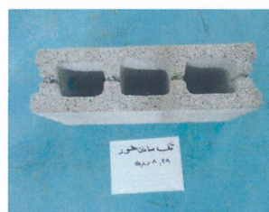
شکل ۱: بلوک های سیمانی به کار رفته در ساخت آزمون
