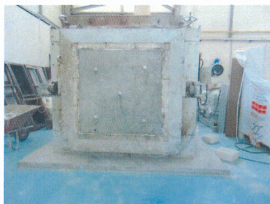
شکل ۴: ترموکوپل‌های نصب شده بر روی وجه
