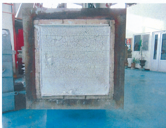
شکل ۷: سطح در معرض آزمونه پس از آزمون
