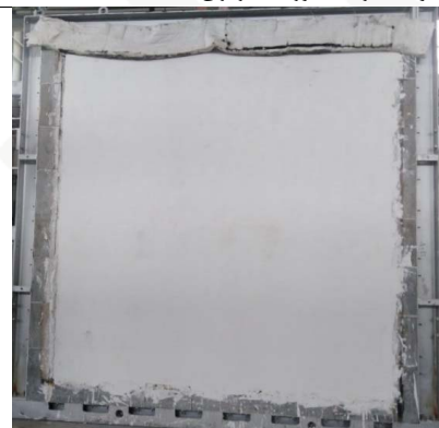
شکل ۴: سطح در معرض با پوشش ۱/۵ سانتی‌متر اندود پایه گچی (قبل از آزمون)
