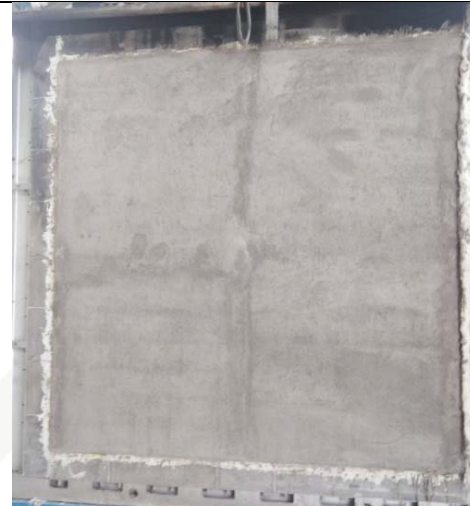
شکل ۳: سطح غیر معرض با پوشش ۲/۵ سانتی‌متر ملات ماسه و سیمان (قبل از آزمون)
