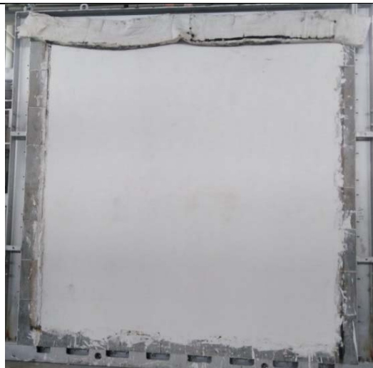
شکل ۴: سطح در معرض با پوشش ۱/۵ سانتی متر اندود پایه گچی (قبل از آزمون)
